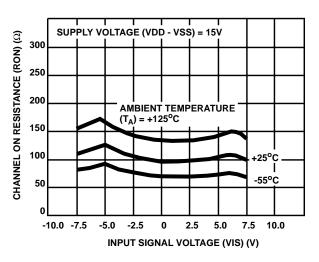
FIGURE 8. TYPICAL ON RESISTANCE vs INPUT SIGNAL VOLTAGE (ALL TYPES)
