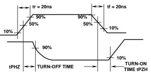
FIGURE 2. PROPAGATION DELAY WAVEFORM, CHANNEL BEING TURNED OFF, ON
